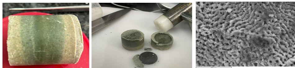
Fig 3. A y B) Detalle de la bentonita Febex compactada a 1.4 \text{ g/cm}^3 tras el desmantelamiento del ensayo estático a 80^\circ\text{C} ; C) Imagen de SEM de los oxi-hidróxidos de Fe formados en la superficie del metal de acero al carbono de Nagra.
