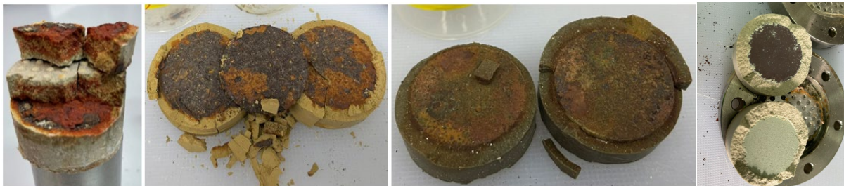
Fig 2. Bentonitas compactadas a 1.4 \text{ g/cm}^3 con el metal de acero al carbono Nagra: A) Febex, B) Czech, C) SWy 3; D) Bentonita FEBEX compactada a 1.4 \text{ g/cm}^3 con metal de cobre SKB.
